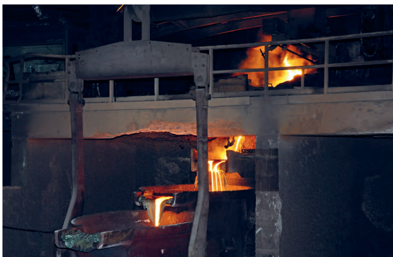
Flytende mangan. Malmen varmes opp til rundt 1700 grader, slik at manganlegeringer smelter og kan skilles ut.
